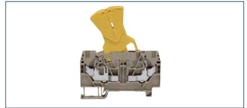
Une borne sectionnable de conducteur neutre est un organe possédant un ou plusieurs points de connexion ainsi qu'une liaison de conducteur neutre réalisable sectionnable, pour raccorder des conducteurs ronds. Les bornes sectionnables de neutre sont également disponibles dans les versions des blocs de jonction multi-étages.
