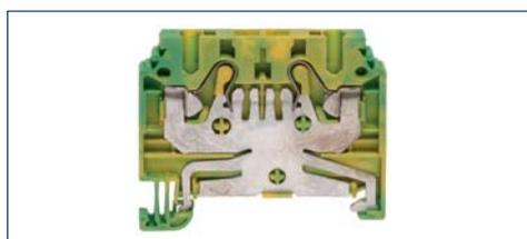
Une borne de terre est un organe possédant un ou plusieurs points de connexion pour raccorder des conducteurs ronds (conducteurs de protection PE/PEN). Les bornes de terre établissent un contact avec le support de montage (rail TS) via le piètement PE par fixation vissée ou par simple enclenchement de la borne sur le rail (pied PE élastique).
