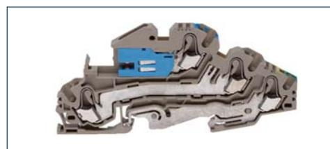
Un bloc de jonction multi-étage est un organe possédant au moins deux niveaux de barrette conductrice, et quatre points de connexion ou plus pour raccorder des conducteurs ronds. Les possibilités de combinaison les plus diverses sont alors possibles : L/PE, L/L, L/N, N/N, N/PE ou L/N/PE, L/L/N, N/N/PE etc.
