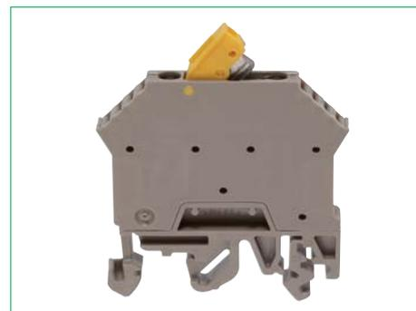
Les modèles **TRK 1,5/STB** et **TRK 1,5/15/STB** offrent l'avantage d'être préfabriqués avec des alvéoles femelles au lieu de vis de pression. Sans autre accessoire, ces bornes sectionnables présentent une alvéole de mesure ou d'essai pour la recherche rapide des défauts ou comme prise de mesure pour compenser des signaux normalisés.
